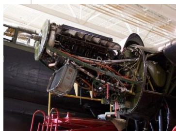
Motorhuset (åbent) på en Avro Lancaster med en Rolls Royce Merlin 224 motor.
